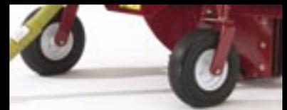
400と600に採用している空気タイヤ式キャスト。スムーズな芝面追従を実現します。800では大型のハイフローテーション・タイヤとトーション・アクスルがエンジン重量を適切に分散しています。
