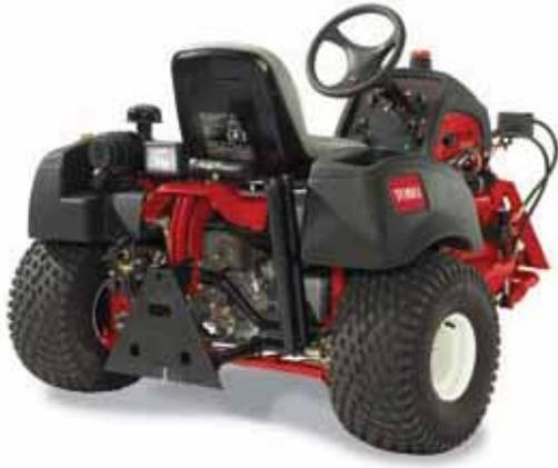
バンカーを最高の美しさに仕上げるために作られた17種類ものアタッチメント。中でも特筆すべきは、SandPro 5040 のために開発された究極のフレックス・ブレードでしょう。油圧装置で上昇下降し、バンカーのすり鉢状の壁ではテンション・スプリングが一定の押圧を維持してくれます。左右に舵取りのできる初めての排土板であり、バンカーの土寄せ、押し固め、成形、均しなどに理想的です。フレックス設計なので、角部でバンカーを傷つけたり、壁を壊してしまうことはありません。スプリング・バランス式の手動ブレードもあります。油圧パワー・ステアリングにより、ハンドリングは軽くて容易。小さいながら簡単に操作の出来る多目的な車両です。
