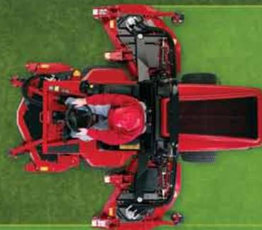
他社のマシンには真似のできないワザがあります。グラウンドマスター 4000-D と 4100-D は、ホイール・ブレーキなどの補助操作なしでゼロターン刈り込みができるので、簡単な往復刈り込みパターンで、刈り残しゼロのきれいな仕事ができます。大きいけれど機敏さ抜群のグラウンドマスター 4000-D と 4100-D は、精確な旋回動作で立ち木の周囲など小さな障害物を避けながらの刈り込みも簡単です。
